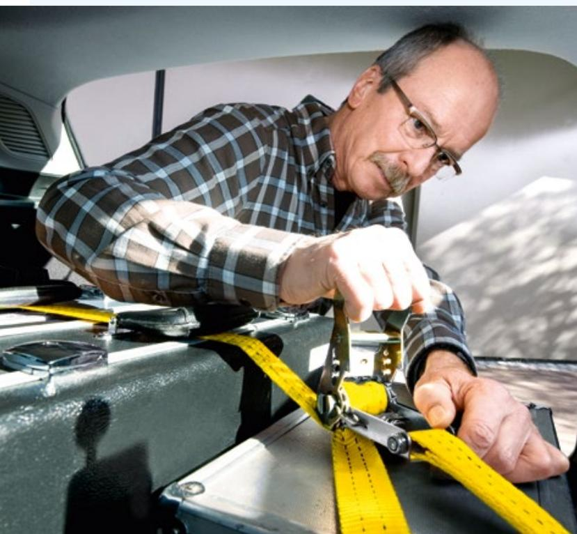
Güter sollten im Fahrzeug stets gut verstaut werden. Sicheres Befestigen der Ladung will gelernt sein.
