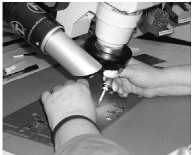
Bild 1. Kolbenlöten mit Absaugung.
