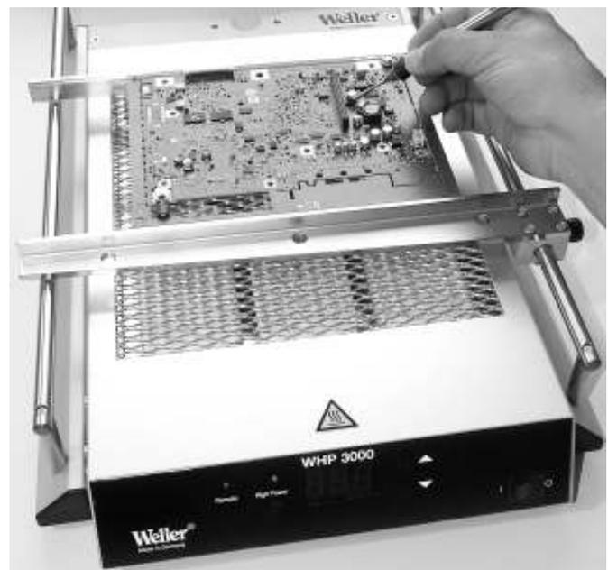
Bild 2. Vorwärmung der Leiterplatte durch Unterheizung.
