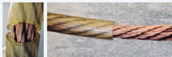
Bild 6 (links): Mit dem Verfahren erkannter Fehler im Leiterseil
