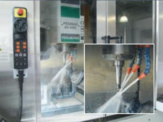
Kapselung ist eine mögliche Schutzmaßnahme. Das Bild zeigt ein Beispiel für den Einsatz von Kühlschmierstoffen.
