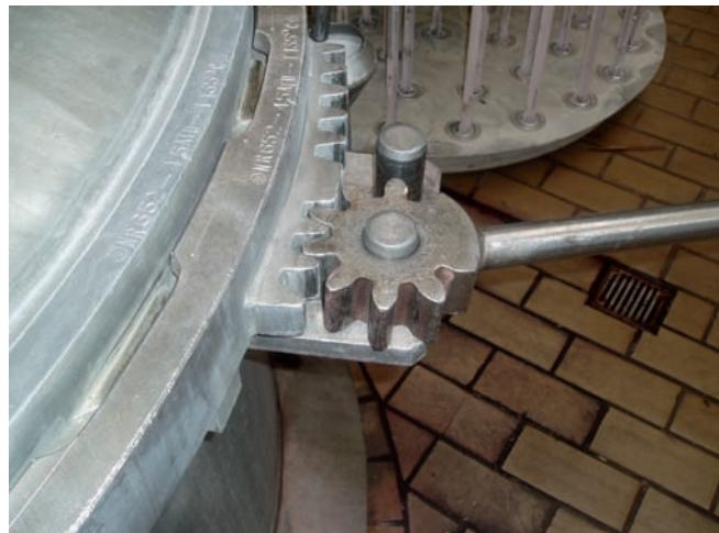
Nicht ohne Grund funktionieren Schnellverschlüsse zweistufig. Der Übergang auf die zweite Stufe ist durch das Umstecken des Zahnhebels mit einer Ruhepause verbunden, in der die Flotte sich beruhigen, Restdampf austreten und Warnzeichen bezüglich des Flottenzustands erkannt werden können.
