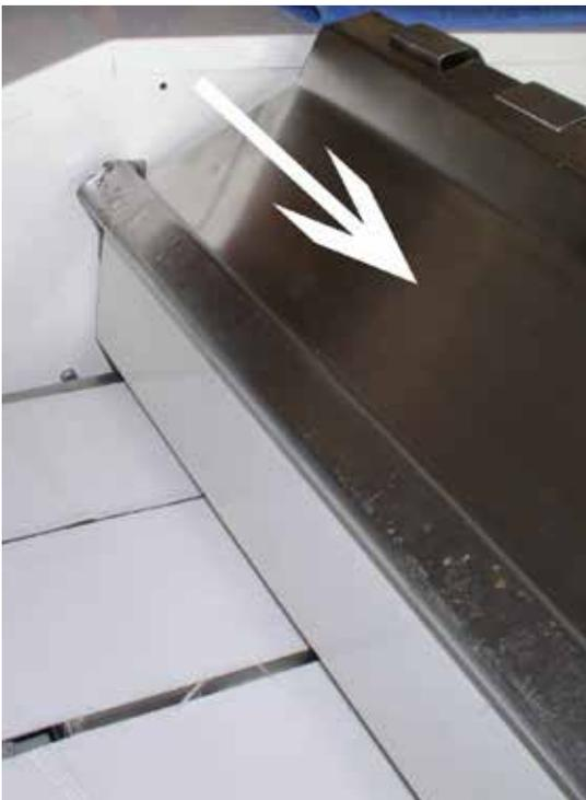
Diese Abdeckung über der Einlass-Schutzeinrichtung (s. Pfeil) verhindert, dass man in den Mangelspalt greifen kann.
