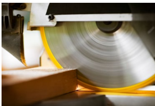
Der Stroboskopeffekt: Es wirkt, als würde das drehende Sägeblatt stillstehen oder sich nur langsam bewegen – eine gefährliche optische Täuschung.
